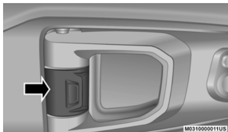
Manual Door Lock
